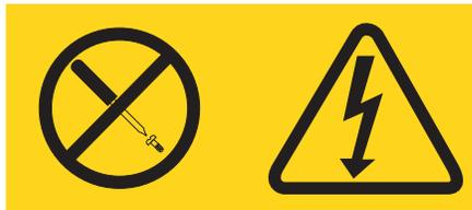
Dentro de cualquier dispositivo que tenga adherida esta etiqueta existen niveles de energía, corriente o voltaje peligrosos. No hay piezas que requieran servicio dentro de estos componentes. Si sospecha de la existencia de algún problema en una de estas piezas, póngase en contacto con el servicio técnico.
